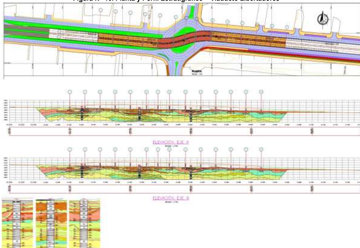
Figura N° 10. Planta y Perfil Estratigráfico – Viaducto Libertadores
